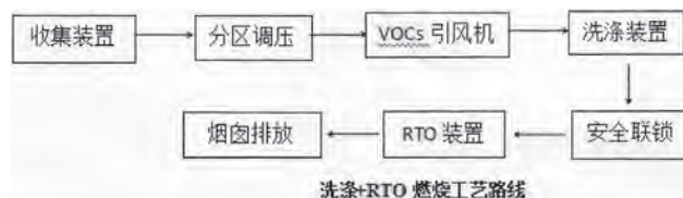
洗涤+RTO 燃烧工艺路线
